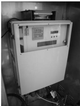
図4 3色のLED光による放流水監視装置の試作品
