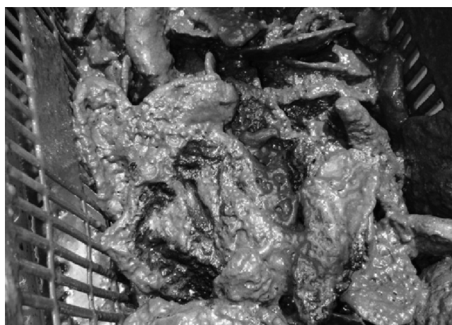
写真2 硝化槽に充填したカキ殻付着汚泥
