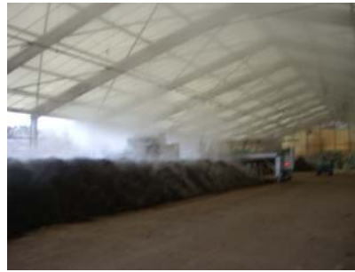
写真2 オープンロータリー 攪拌発酵槽（攪拌前） 写真3 オープンロータリー 攪拌発酵槽（攪拌後の湯気の発生） 写真4 スクープ攪拌発酵槽
