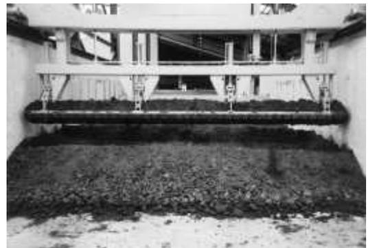
写真1 堆肥クレーンによる切り返し作業
