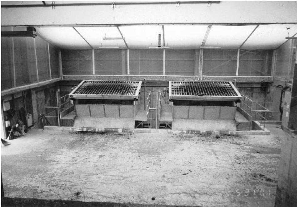
写真 堆肥化装置の原材料の異物除去装置
