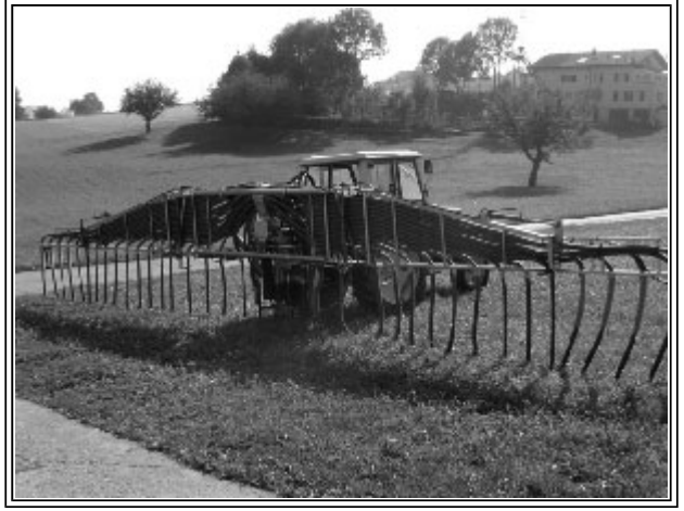
写真4 現在、主流になっている糞尿散布機。折り畳み式であり、窒素ロスを少なく抑えられる(フィリッシュコップ農場)。
