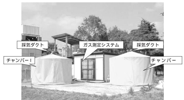
写真1 チャンバーを用いた堆積式堆肥からの環境負荷ガス揮散測定システム(長田ら)
