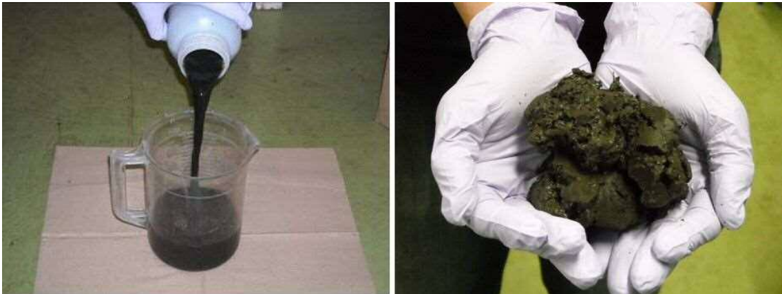
参考：写真1 湿式メタン法および乾式メタン法の残さの様子 左：湿式メタン発酵の消化液、右：乾式メタン発酵の残さ（粘土状）
