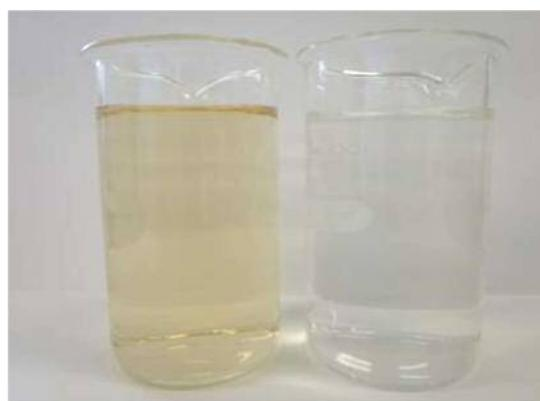
写真1 微細気泡オゾンによる脱色処理
