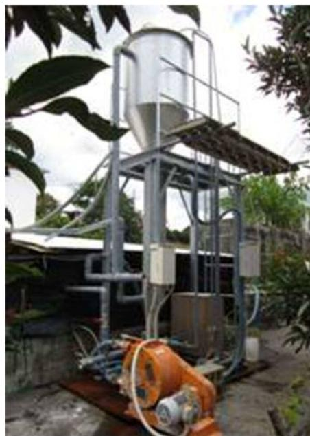
写真2 MAP反応槽(有効容積0.7m<sup>3</sup>)
