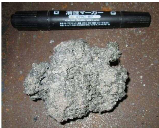
図4 燃焼中に発生した熔融物の例
