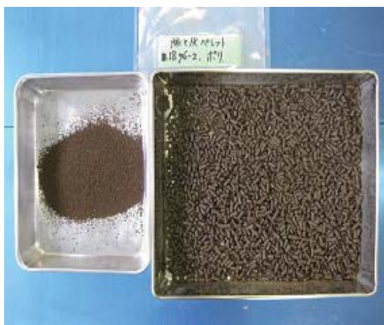
写真1 崩壊劣化したペレットと正常ペレット
