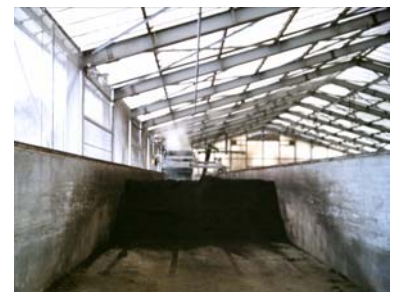
写真2 オープンロータリー 攪拌発酵槽（攪拌前） 写真3 オープンロータリー 攪拌発酵槽（攪拌後の湯気の発生） 写真4 スクープ攪拌発酵槽
