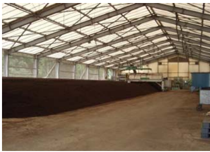
写真2 オープンロータリー 攪拌発酵槽（攪拌前） 写真3 オープンロータリー 攪拌発酵槽（攪拌後の湯気の発生） 写真4 スクープ攪拌発酵槽
