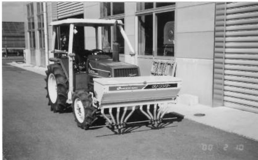
写真1 成型堆肥の施用に利用できる石炭散布機 (条施用のセット)
