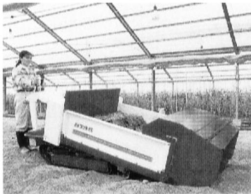
図4 自走式積込み・散布堆肥散布機
