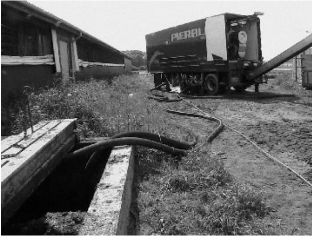
写真4 移動型固液分離装置。左手前のスラリー貯留槽から吸引し、左のタンクとトラックに分離した液分と固形分を排出している。装置は、トラックによって牽引できるトレーラー内に、コントローラー、カッターポンプ、固液分離器、燃料等の稼働に必要な全てが搭載されていた。また、トラブルが生じた際には、自動で携帯電話に知らせるようになっていることから、1度作動させた後は無人運転が可能とのことである。
