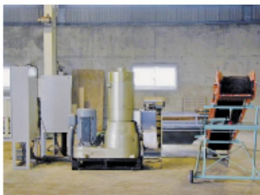
成分調整成型堆肥の製造システム
