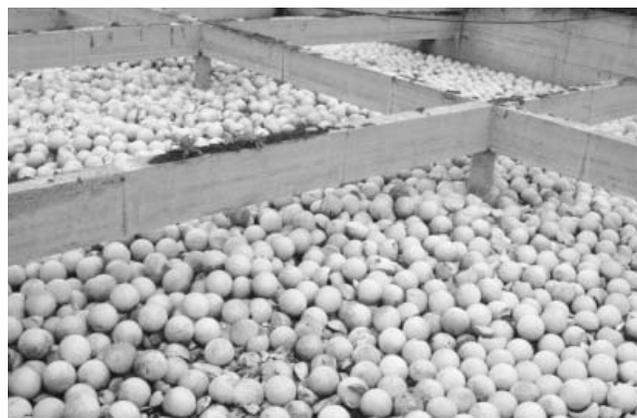
図8 スラリーに発泡スチロールのボールでフタをする試験
