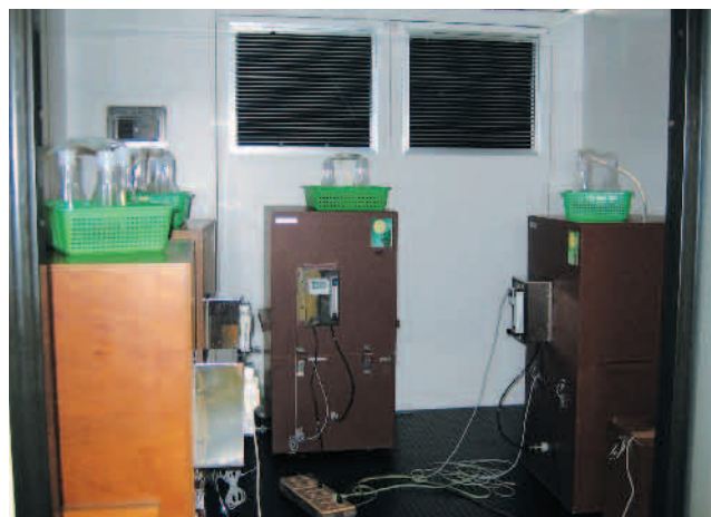
小型堆肥発酵装置「かぐやひめ」による 各種資材アンモニア吸着効果試験
