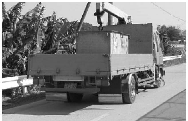
【ユニック車によるフタ付き容器の運搬】
