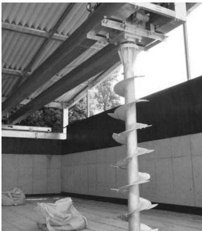
写真2 縦型発酵攪拌機
