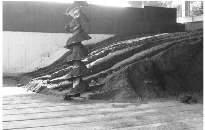
写真4 攪拌機とフロア配管
