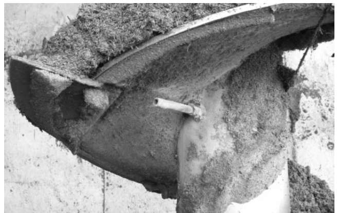
写真5 切削羽とノズル
