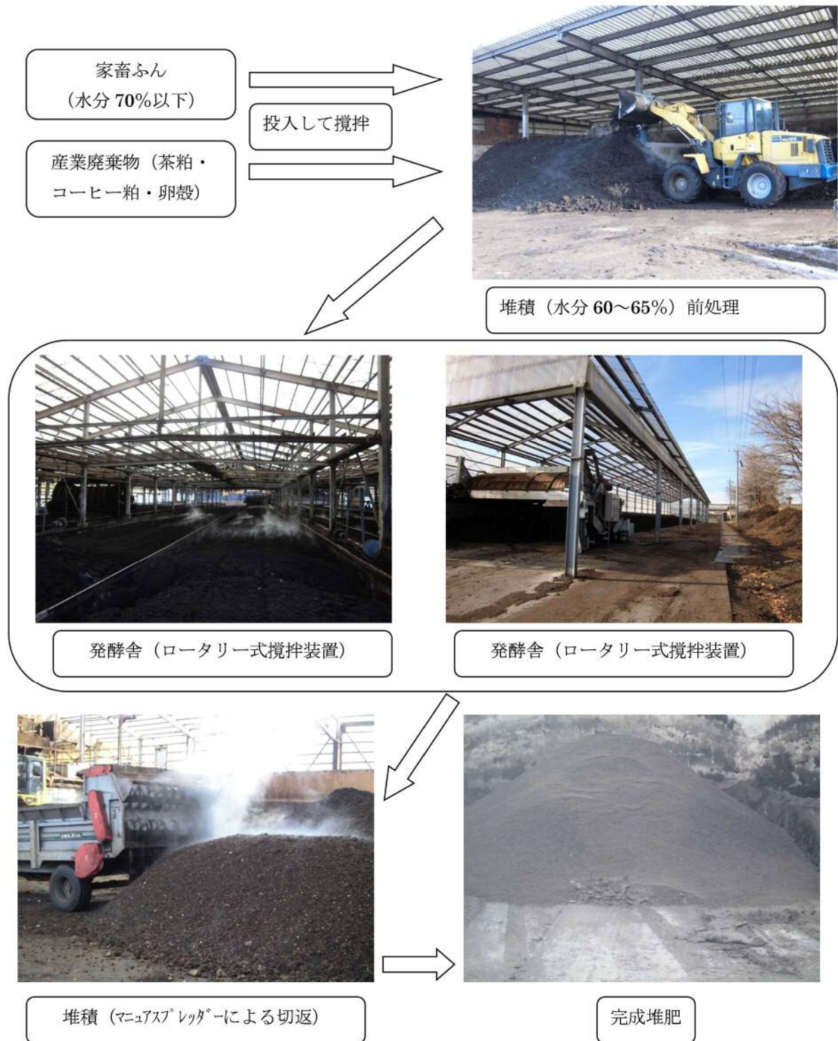
図5 横野堆肥センターにおける堆肥生産のフロー
