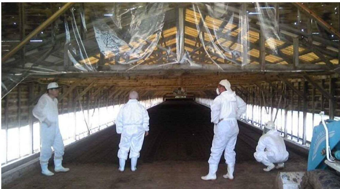
写真 6 鶏ふん乾燥施設のアンモニアと温室効果ガス測定 (石川県 H 市 : 1512m<sup>3</sup> 幅 7.5m × 長さ 73.3m × 高さ 3.5m)
