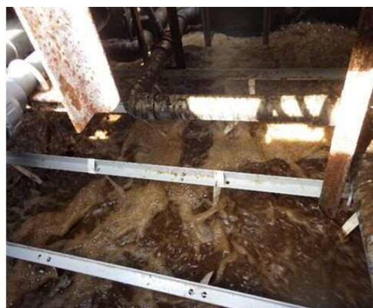
写真 3 炭素繊維担体リアクターによる養豚排水浄化実証試験 (岡山県 N 市：畜舎汚水処理施設、100m<sup>3</sup>浄化槽への適応試験)
