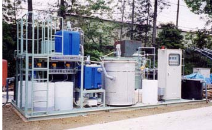
図1 脱色処理システム実証実験装置
