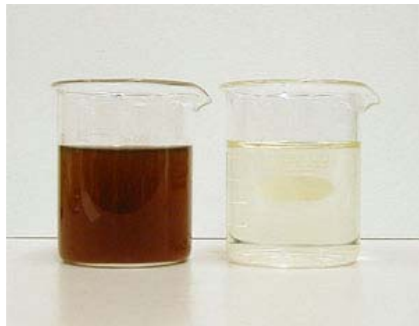
図3 牛舎廃水脱色処理前後
