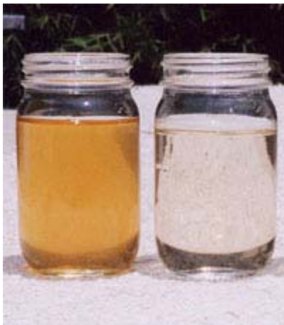
図2 豚舎廃水脱色処理前後
